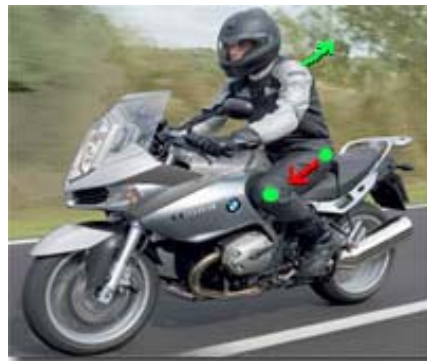
Figura 4: Durante la frenada, la presión sobre las rodillas, contiene la inercia del piloto, y permite incorporarse de la moto, sin cargar de peso el manillar.
