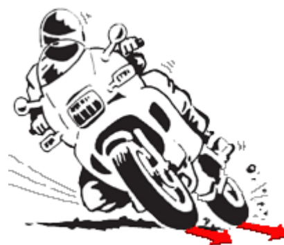
Figura 6: Durante la tumbada, los neumáticos sufren una fuerte carga lateral, que alcanza su máxima expresión justo antes de la aceleración
