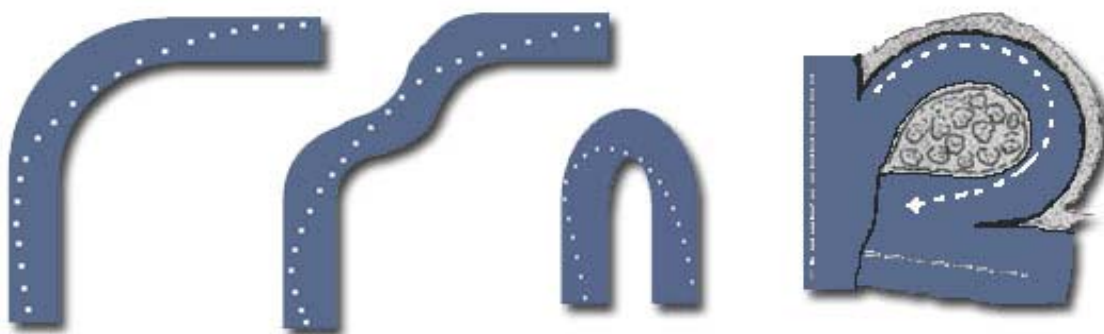
Figura 2: Trazados en distintos tipos de curvas (solo está representado el carril por el que se circula).
